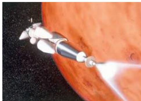
L'efficacité d'un moteur dépend notamment de la température du gaz qui s'échappe de la tuyère, et avec le plasma, on atteint des sommets. La température d'un plasma atteint les dizaines de milliers de degrés, voire le million de degrés, quand les moteurs chimiques traditionnels atteignent à peine les quelques milliers de degrés.
